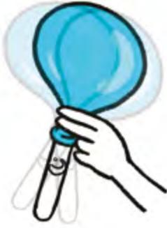
5) Récupérez le ballon en évitant le plus possible que le gaz ne s'échappe et mettez l'ouverture du ballon autour du tube à essai contenant de l'eau de chaux. Secouez.
