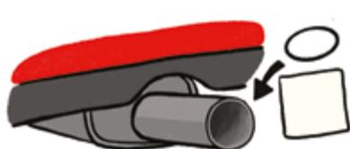
1) Fixer, à l'aide d'un élastique, une compresse sur l'embout du pot d'échappement de chaque véhicule.
